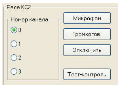
Рисунок 31 – Панель управления реле контроллеров связи версий М и Н
