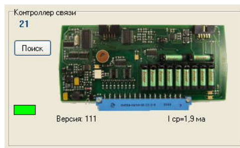
Рисунок 18 – Панель "Контроллер связи" с обнаруженным контроллером связи версии M
